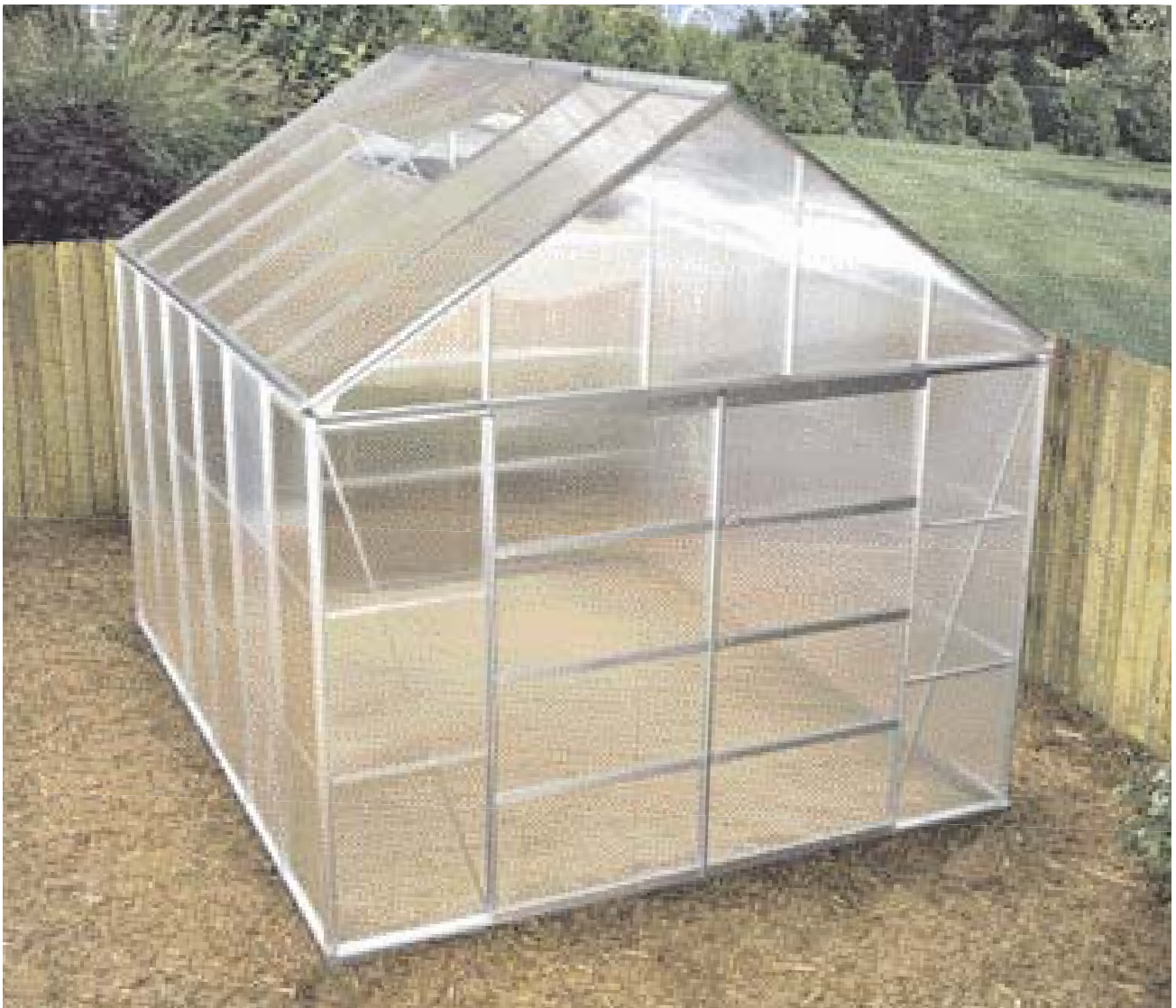
Sellel kasvuhoonel on alumiiniumsõrestik ja polükarbonaadist paneelid. Kasvuhoone on varustatud lükanduste ja katuseluugiga. (Vt lk 78.)
